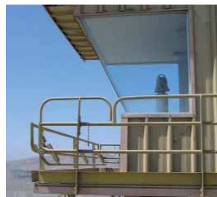
Рис.7 Специальное помещение для размещения электронного тахеометра на карьере
