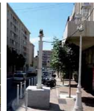
Рис.8 Временный пилон с электронным тахеометром (Франция)
