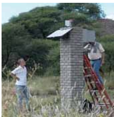
Рис.3 Спутниковый приемник с антенной сети базовых станций De Beers (Австралия)
