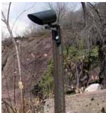
Рис.9 Металлический стакан защищает отражатель от пыли, дождя и снега (Италия)
