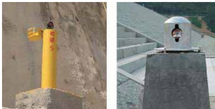
Рис.10 Примеры защиты отражателей от пыли, дождя, снега и вандалов (Китай)
